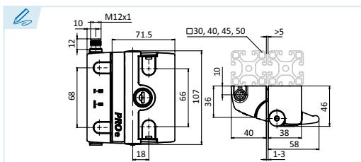
**Características:** Clavija M12 de 8 polos, para puerta a izquierda o derecha, posición de la clavija en la parte inferior o superior. Voltaje: 24V. Certificado UL, según B6. Categoría de seguridad 4, PLe.
